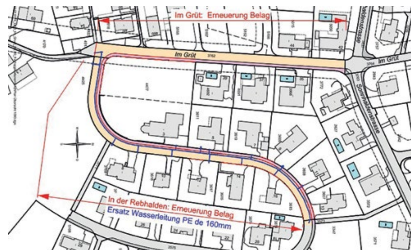
Übersichtsplan Strassensanierung «Im Grüt / In der Rebhalden».
